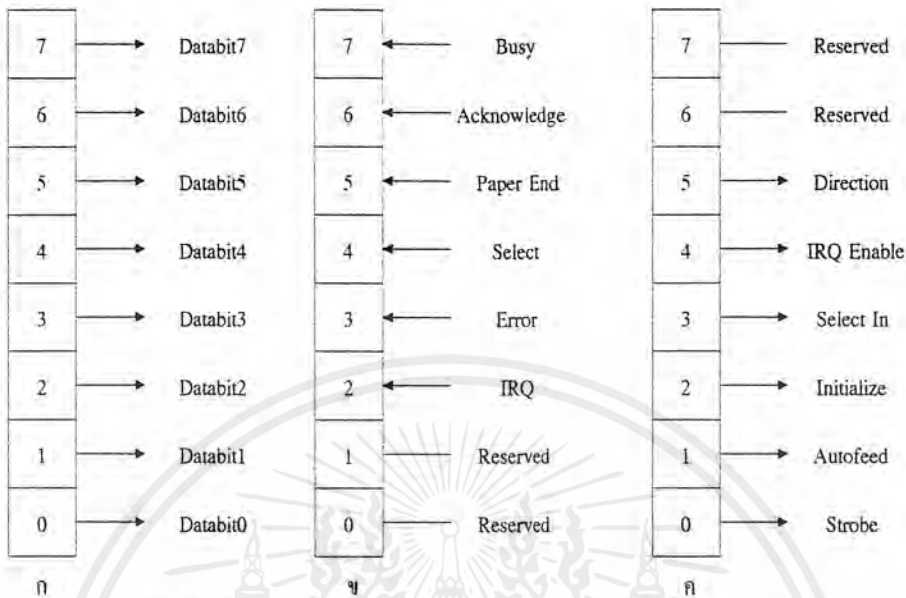
รูปที่ 10.1 แสดงหน้าที่ของแต่ละบิตในรีจิสเตอร์ ก) รีจิสเตอร์ข้อมูล ข) รีจิสเตอร์สถานะ ค) รีจิสเตอร์ควบคุม
