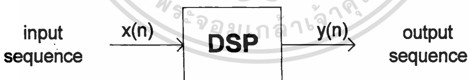
รูปที่ 1.1 DSP เปลี่ยน Input Sequence x(n) ให้เป็น Output Sequence y(n)
