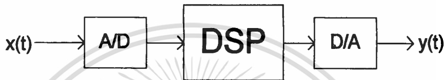
รูปที่ 1.2 การเปลี่ยนไปมาระหว่าง Analog Signal กับ Digital Signal
