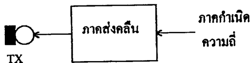
รูป 3.3 แสดงแผนผังของวงจรภาคส่งคลื่นอุลตราโซนิก
