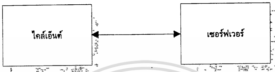
รูปที่ 1 โมเดลไคลเอ็นต์เซิร์ฟเวอร์ จะมีคอมพิวเตอร์เครื่องหนึ่งขอใช้บริการและอีกเครื่องให้บริการ
