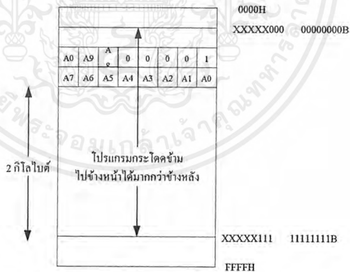
ภาพที่ 4.11 (ต่อ) ขอบเขตในการกระโดดไปทำงานของคำสั่ง AJMP
