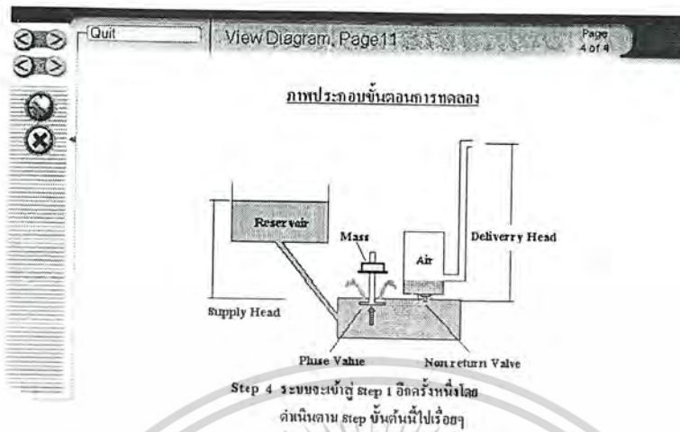
รูปที่ 4.17.11 ภาพประกอบขั้นตอนการทดลอง (ต่อ)
