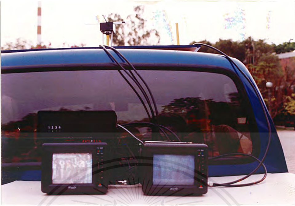
รูปที่ 5.15 แสดงภาพการเปรียบเทียบภาพที่รับได้จากสายอากาศทั้งสองแบบ เมื่อเครื่องรักษาระดับสัญญาณเปลี่ยนมาใช้สายอากาศแบบไขว้ชุดที่ 2
