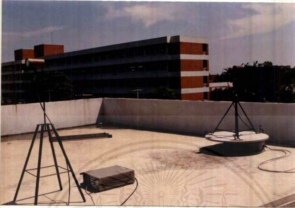
รูปที่ 4.24 แสดงการจัดสายอากาศส่งและรับเพื่อวัดเพทเทอร์นของสายอากาศ
