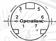
รูปที่ 2.3 ภาพแสดงลักษณะของเซ็นเซอร์แก๊สคาร์บอนมอนนอกไซด์
