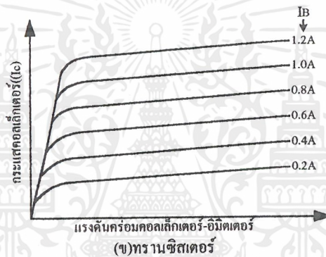
รูปที่ 3.13 การเปรียบเทียบคุณสมบัติทางเอาท์พุทของมอสเฟตกำลังและไบโพลาร์ทรานซิสเตอร์
