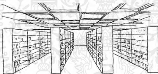
รูปที่ 3.24 แสดงการให้แสงสว่างในระบบตาราง (Grid pattern)
