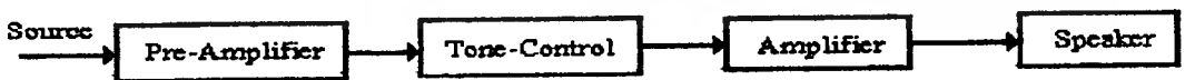
รูปที่ 1.1 ส่วนประกอบหลักของระบบเสียงในบ้านทั่วไป
