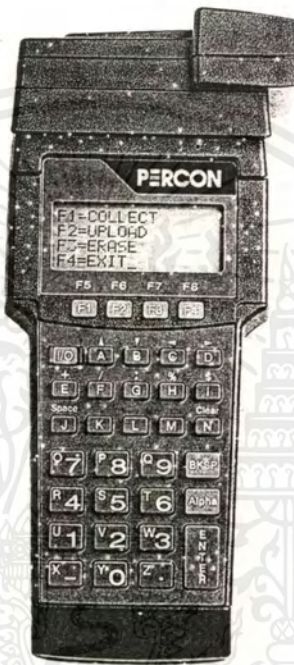
รูปที่ 3.11 เครื่องอ่านรหัสแท่งแบบพอร์ทเทเบิล
