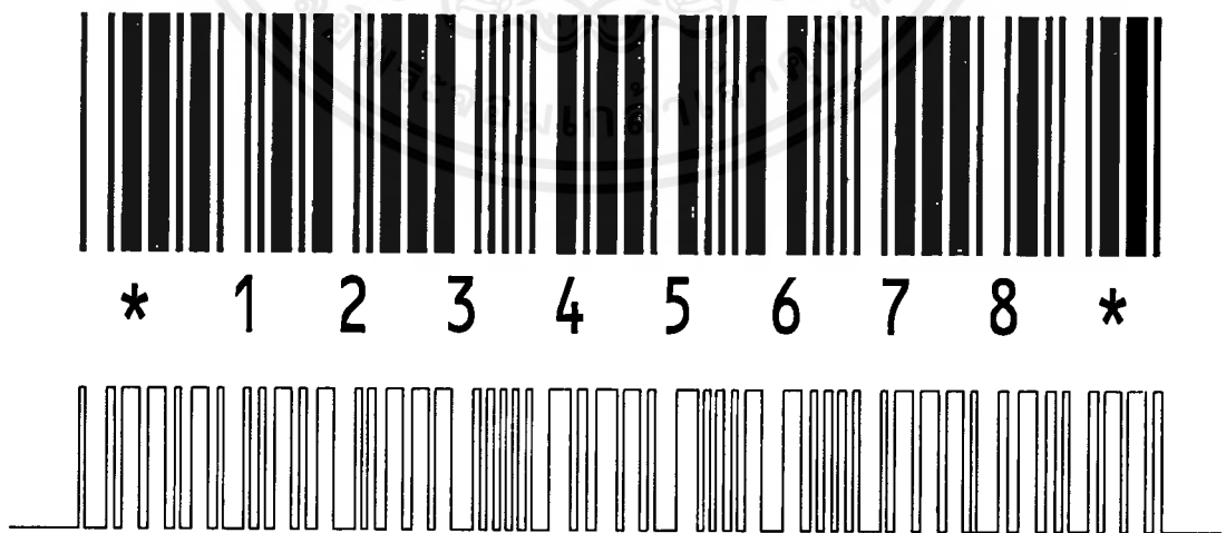
รูปที่ 6.2 สัญญาณที่ได้จากหัวอ่านรหัสแท่ง
