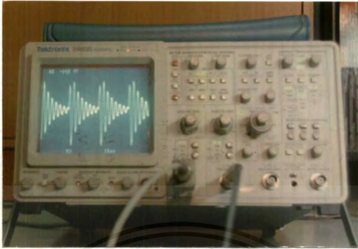
รูปที่ 4.7 แสดงสัญญาณเอาต์พุตเมื่อจีแบบสเปร์รี่ตั้ง Volume ต่ำสุด
