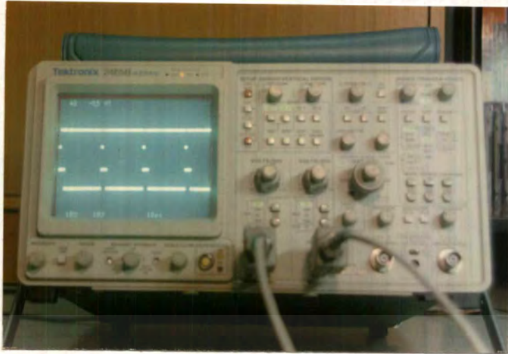
รูปที่ 4.2 แสดงสัญญาณ 35 kHz จาก IC U3 และ U4
