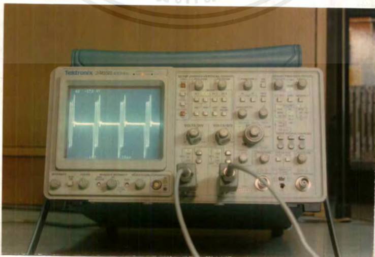
รูปที่ 4.4 แสดงสัญญาณจากภาคมอดูเลเตอร์เมื่อจี้แบบสเปิร์ช
