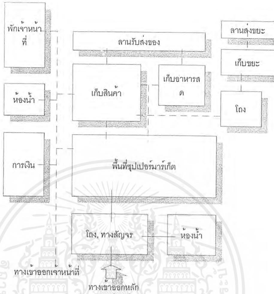
แผนภูมิที่ 3.9 แสดงความสัมพันธ์ขององค์ประกอบย่อยส่วนซูปเปอร์มาร์เก็ต
