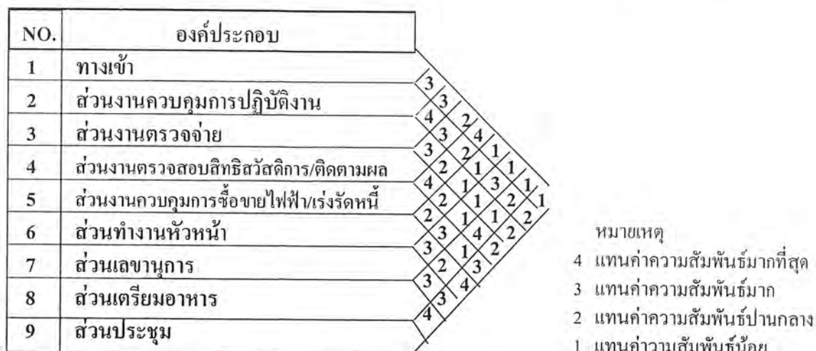
ภาพที่ 4.8 (ก) แสดงค่าความสัมพันธ์ขององค์ประกอบในส่วนแผนกควบคุมการปฏิบัติงาน
