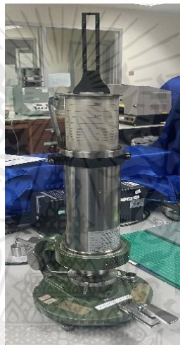
รูปที่ ข.1.4 เครื่องสำหรับการทดสอบการทนต่อการซึมผ่านของอากาศ
