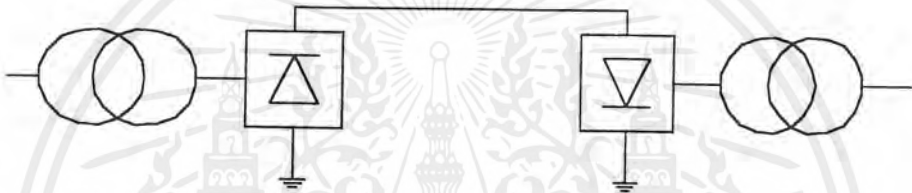
รูปที่ 2.1 วงจรส่งกำลังไฟฟ้าแบบขั้วเดียว
