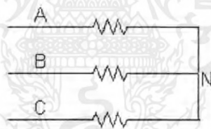
รูปที่ 4.2 รูปแสดงการต่อโหลดแบบสตาร์ของโหลด R ในวงจรทดสอบ
