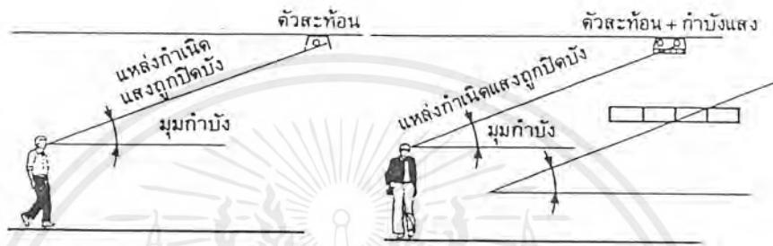
รูปที่ 3.1 แสดงการควบคุมแสงจ้าโดยมุมกำบัง
