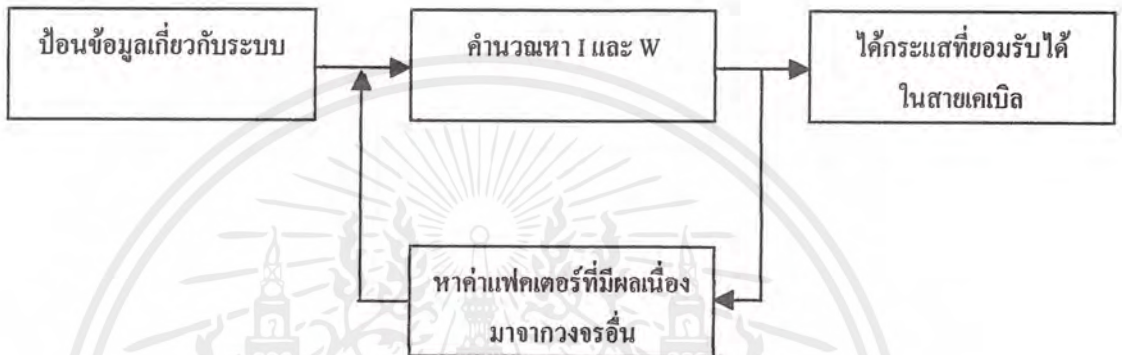
รูปที่ 6.1 แผนภาพแสดงขั้นตอนการทำงานของโปรแกรม
