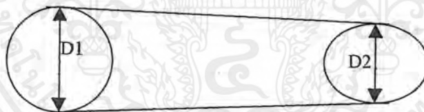
มู่เฒ่าตัวใหญ่ติดตั้งทางค้ำนมอเตอร์ มู่เฒ่าตัวเล็กติดตั้งทางด้านเครื่องกำเนิดไฟฟ้า
