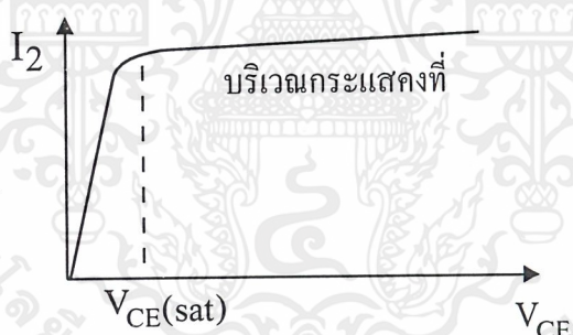
รูปที่ 2.24 คุณลักษณะกระแสด้านเอาต์พุตของตัวสะท้อนกระแสพื้นฐานที่ใช้ BJT
