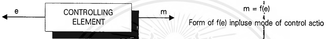
รูปที่ 2.3 Controlling Element or Controller ของระบบควบคุมอัตโนมัติ
