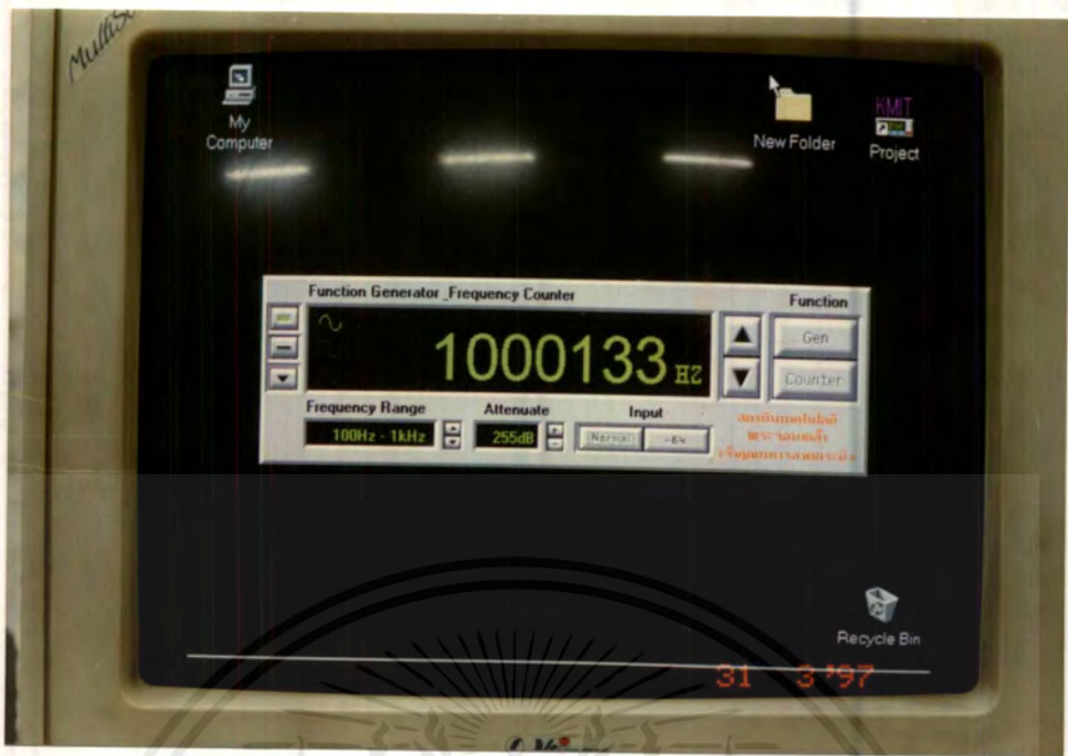
รูปที่ 4.21 แสดงการวัดค่าสัญญาณจากฟังก์ชันเจนเนอเรเตอร์ความถี่ 1 MHz วัดค่าได้ 1.000133 MHz ผิดพลาด 0.000133%
