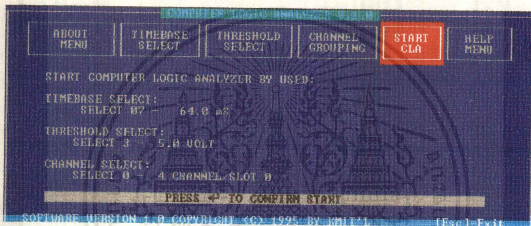
รูปที่ 5.2.28 เมนู Start CLA จะแสดงค่าทั้งหมดที่ตั้งไว้ให้ดูก่อนการเริ่มต้นวัดสัญญาณ
