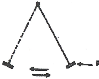
รูปที่ 7 เปรียบเทียบการส่งพลังงานจากกลุ่มอิเล็กตรอน ให้กับสัญญาณไมโครเวฟกับการไกวชิงช้า
