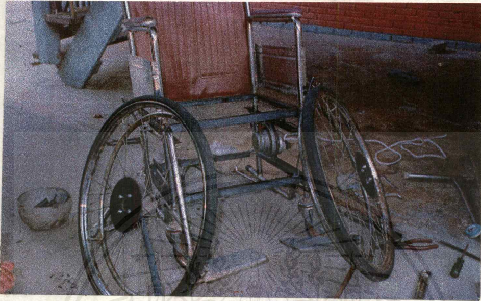
รูปที่4.4 รูปแสดงการยึดมอเตอร์และเตรียมประกอบล้อหลัง
