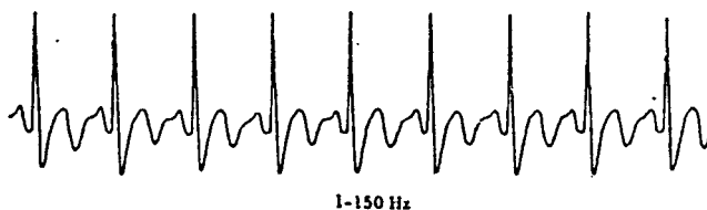
(c) แสดงคลื่นสัญญาณไฟฟ้าหัวใจในกรณีมีความเพี้ยนที่ความถี่ต่ำ
