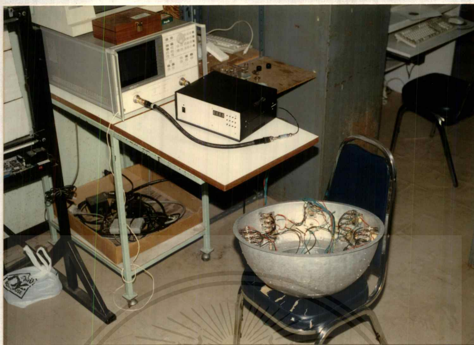
รูปที่ 4.14 แสดงการต่อเครื่องควบคุมเฟสเข้ากับเน็ตเวิร์คออนไลน์เซอร์
