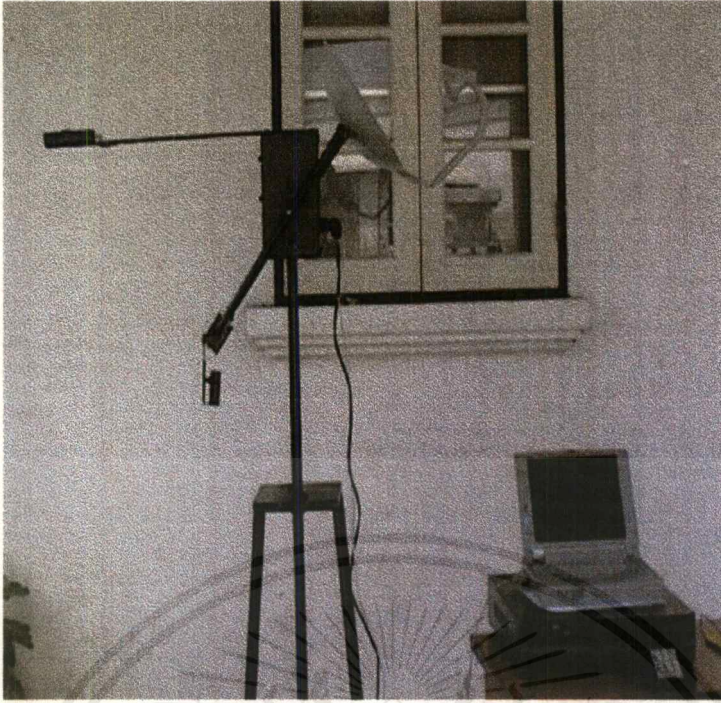
รูปที่ 4.2 แสดงการหมุนหาทิศเหนือของจานรับสัญญาณดาวเทียม
