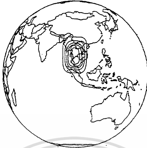
รูปที่ 2.14 ฟูคปรินท์ของดาวเทียมไทยคมในย่านความถี่ KU
