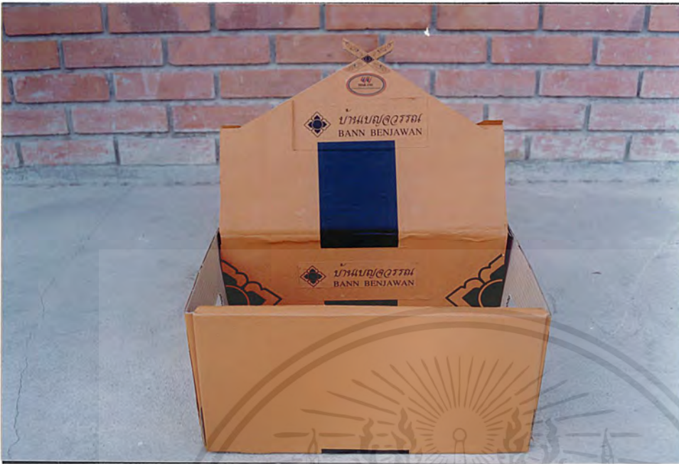
ภาพที่ 4.31 แสดงการใช้งานหุ่นจำลองของกล่องบรรจุภัณฑ์เทียนเพื่อการขนส่ง
