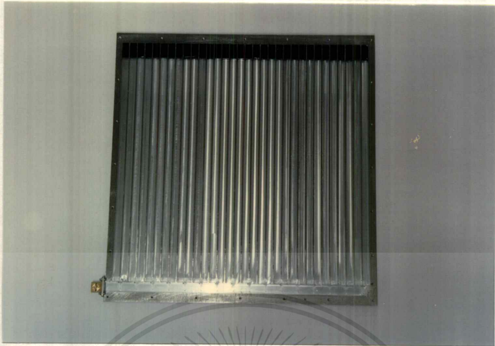
รูปที่ 3.3 แสดงสายอากาศส่วนที่เป็นท่อนำคลื่นหลักและท่อนำคลื่นสาขา
