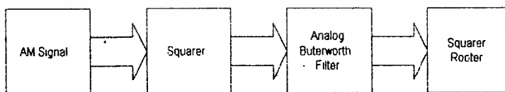
รูปที่ 2.26 แสดงบล็อกโคโอะแกรมของวงจร Square Law Detector
