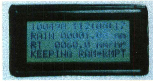
รูปที่ 4.9 แสดงการเปลี่ยนแปลงหน้าจอ LCD เมื่อมีสัญญาณเข้ามาที่ขาอินเทอร์รัปต์
