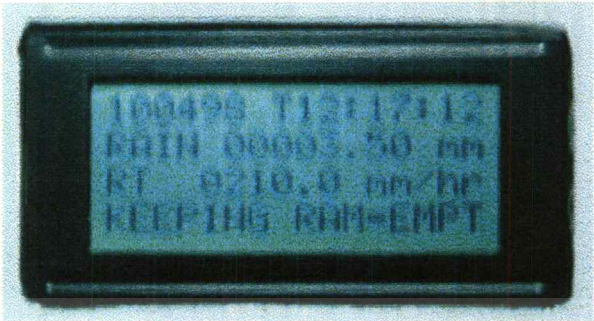
รูปที่ 4.17 แสดงหน้าจอ LCD หลังจากมีการกดปุ่มควบคุมการบันทึกข้อมูลของปริมาณน้ำฝน
