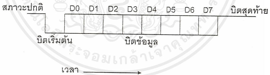
รูปที่ 3.13 รูปแบบของสัญญาณข้อมูลอนุกรมในโหมด 1 ซึ่งมีลักษณะเดียวกับรูปแบบของการสื่อสารแบบอะซิงโครนัสที่ใช้ข้อมูล 8 บิต บิตเริ่มต้นและบิตสุดท้ายอย่างละ 1 บิต
