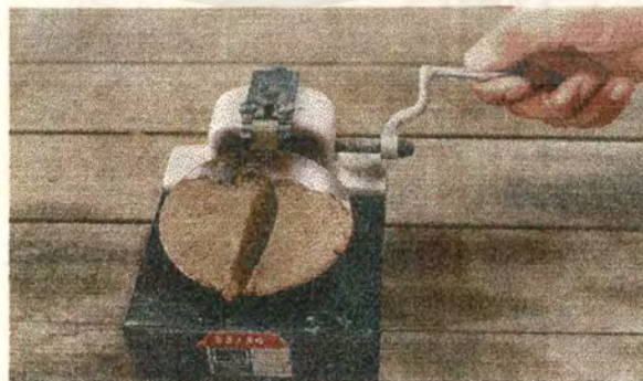
รูปที่ 3.1.3 ขั้นตอนการทดลอง Liquid Limit
