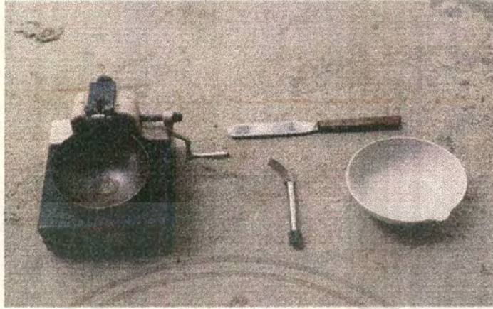
รูปที่ 3.1.2 อุปกรณ์ที่ใช้ในการทดลอง Liquid Limit
