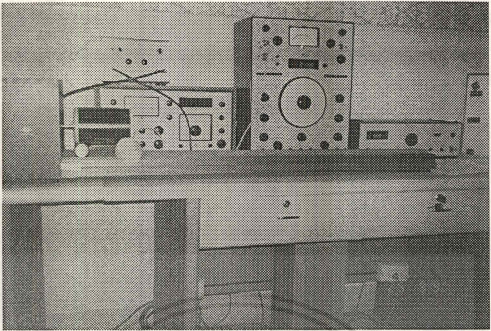
รูปที่ 3.6 รางเดิน และ ชุดเครื่องมือทดสอบ Standing Wave
