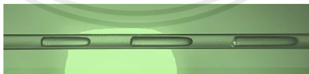
รูปที่ 4.12 การไหลแบบ Slug flow
