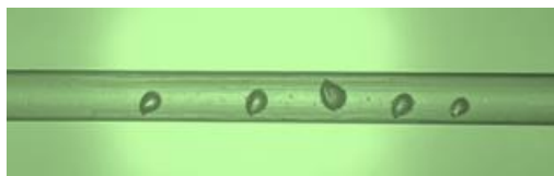
รูปที่ 4.10 การไหลแบบ Bubbly flow
