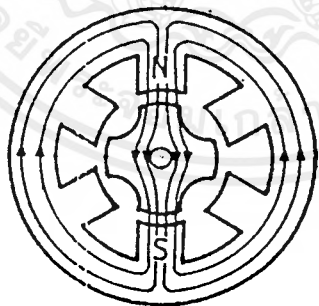
รูปที่ 2.7 แสดงเส้นแรงแม่เหล็กและกระตุ้นเฟส 1
