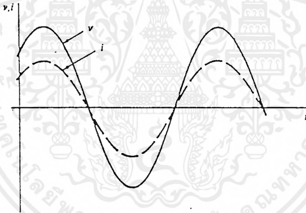
รูปที่ 2.2 รูปคลื่นของแรงดันและกระแสของตัวต้านทาน
