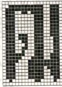
รูปที่ 4.12 กลุ่มของพิกเซลติดกันที่รวมกันเป็นเลขทะเบียน
