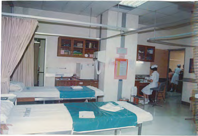
ภาพที่ 2.101 TREATMENT ROOM บริเวณตู้เก็บอุปกรณ์ SINK เป็น เฟอร์นิเจอร์ Build in เป็นวัสดุคงทน แต่ดูแลรักษายาก เพราะเป็นส่วน ทำงานพยาบาลและมีสารต่างๆมาก
