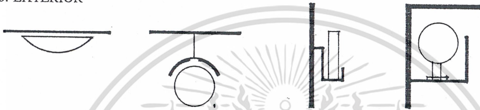
ภาพที่ 3.3.5.2-2 การติดตั้งดวงโคมชนิด FLUORESCENT LAMPS
