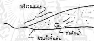
ภาพที่ 3.24 แสดงระบบการระบายน้ำใต้ดินโดยตัวตัด
