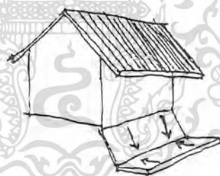
รูปที่ 3-28 แสดงการระบายน้ำฝนโดยระบบระบายเอียงและแอ่ง
