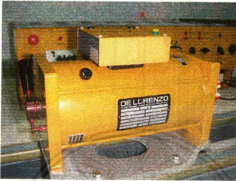
รูปแสดง มอเตอร์ที่ใช้ในการทดลอง มีขนาดตาม nameplate ดังนี้ 1\sim M , 230V, 3.5A, 230W, \cos\phi 0.8, 3000rpm, 50Hz
