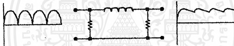
รูปที่ 4.6 วงจรกรองกระแสโดยใช้ตัวเหนี่ยวนำ
