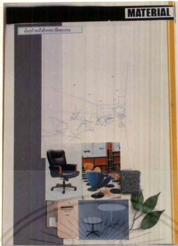
ภาพที่ 66 แสดงการใช้วัสดุในการตกแต่งห้องหัวหน้าฝ่ายสถาปัตย์ พื้น เป็นพรมสีเขียวเพื่อให้รู้สึกสดชื่น กระฉับกระเฉงสบายตา ผ้าม่าน ภายในกรุกระจก ไม้ เพื่อความโปร่งและสวยงาม ฝ้า ยิปซัมบอร์ดฉาบเรียบเซาะร่องเดินเส้นอลูมิเนียม ความสูง 2.80 ม. ใช้ไฟ DOWN LIGHT เฟอร์นิเจอร์ รูปแบบทันสมัยและใช้สีเข้ม เพื่อให้ดูภูมิฐาน
